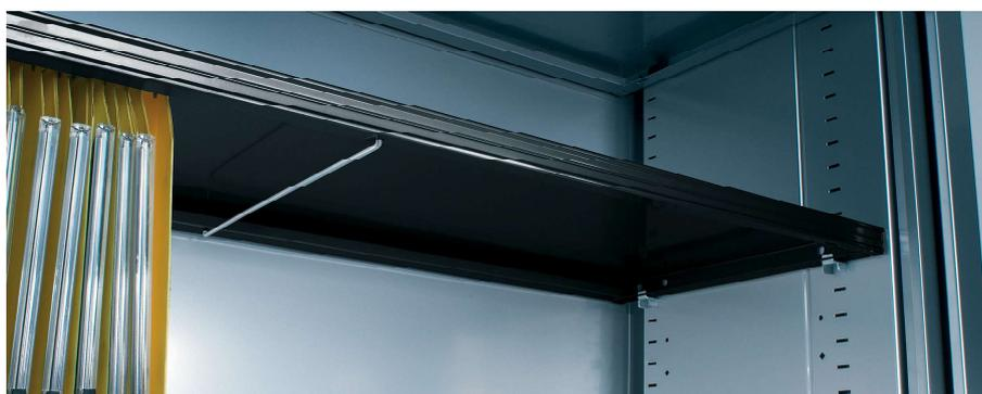
**Renfort central de la tablette 120** pour éviter la déformation. Pli écrasé permettant le **classement de dossiers suspendus**. **Charge supportée : 110 kg**, en conformité avec les normes. **Tablettes intégrées dans les armoires** (coloris noir, sauf armoires Passe-partout, sur demande. en blanc : tablettes blanches), fixées par 4 taquets métalliques.
